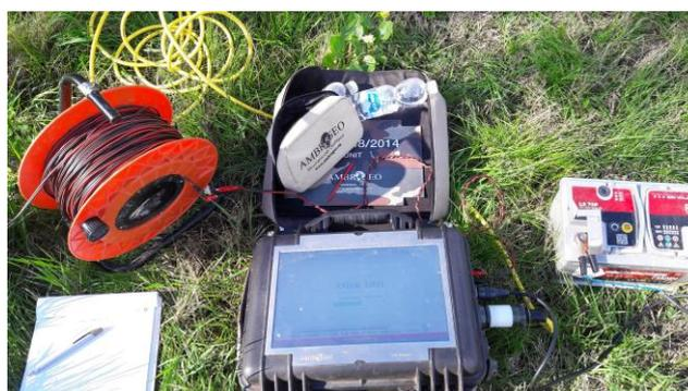
Figura 2: Sismografo digitale a 24 bit.
