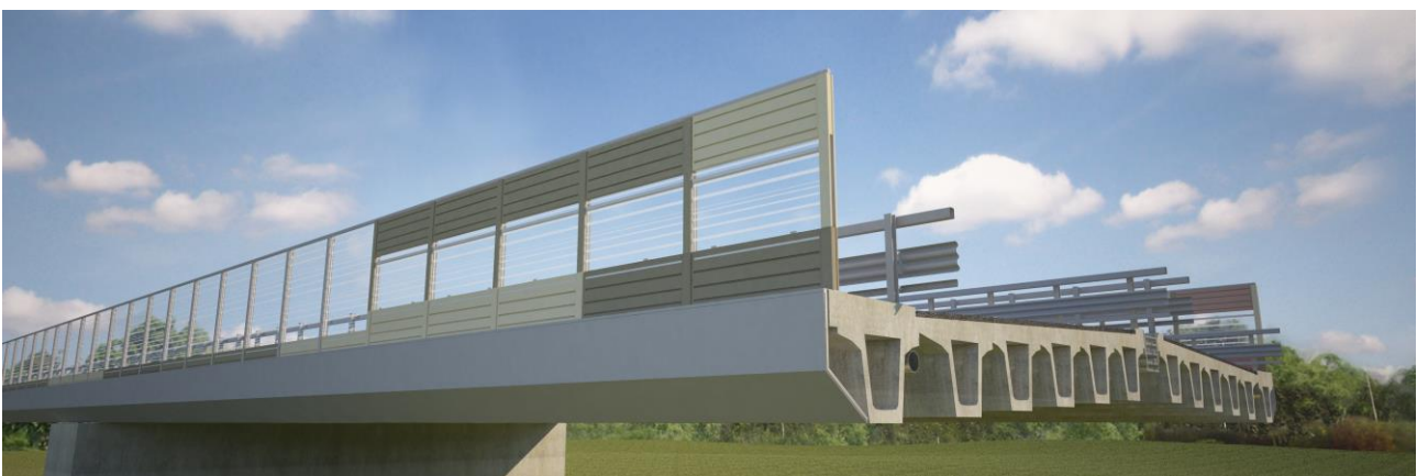
FIGURA 4-30 – SOLUZIONE ARCHITETTONICA VIADOTTO CON IMPALCATO IN CAP
