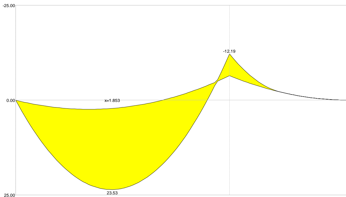
Figura 18 – Diagramma involuppo momento flettente [kNm]
