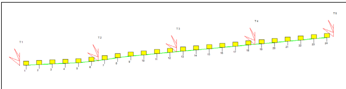
Schema di esecuzione indagine sismica a rifrazione
