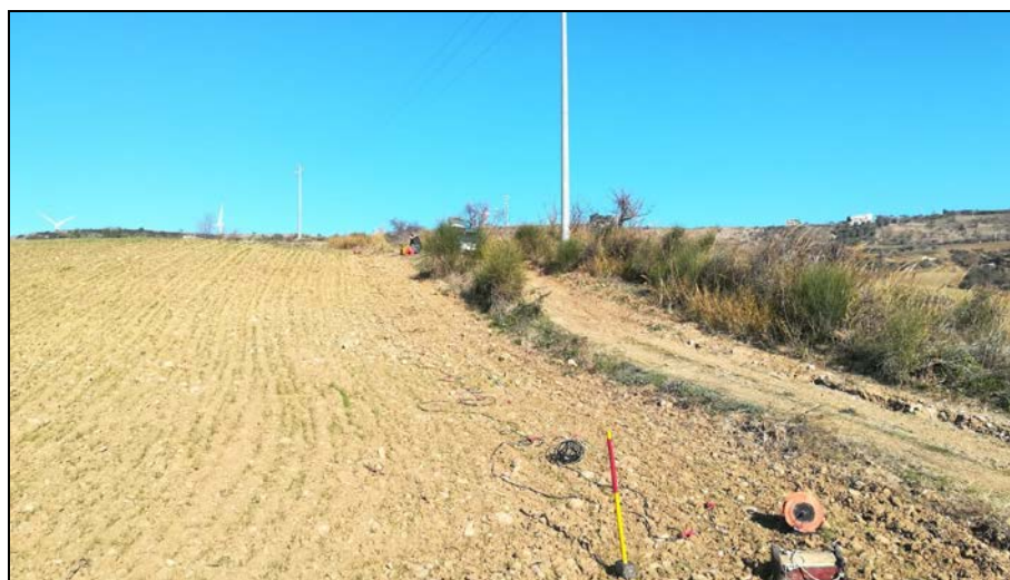
Esecuzione indagine sismica a rifrazione 1
