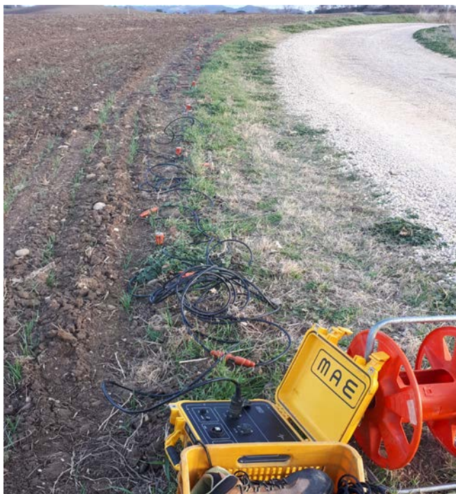
Esecuzione indagine sismica a rifrazione 2
