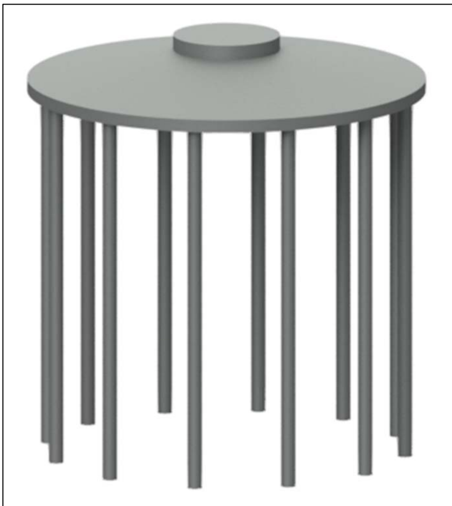
Figura 1: vista tridimensionale della fondazione dell'aerogeneratore
