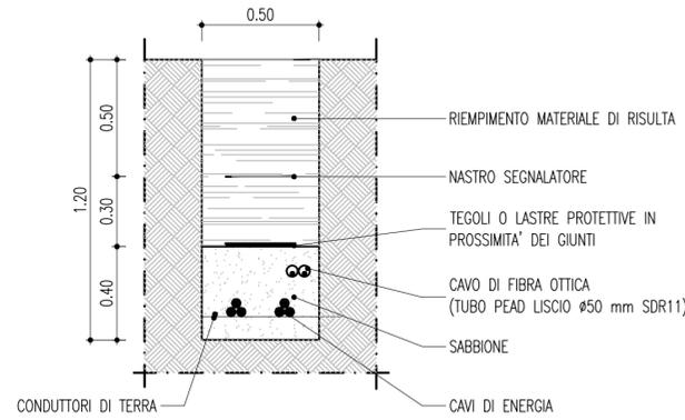
SEZIONE TIPO 2D - SU STRADE IN MISTO CEMENTATO
