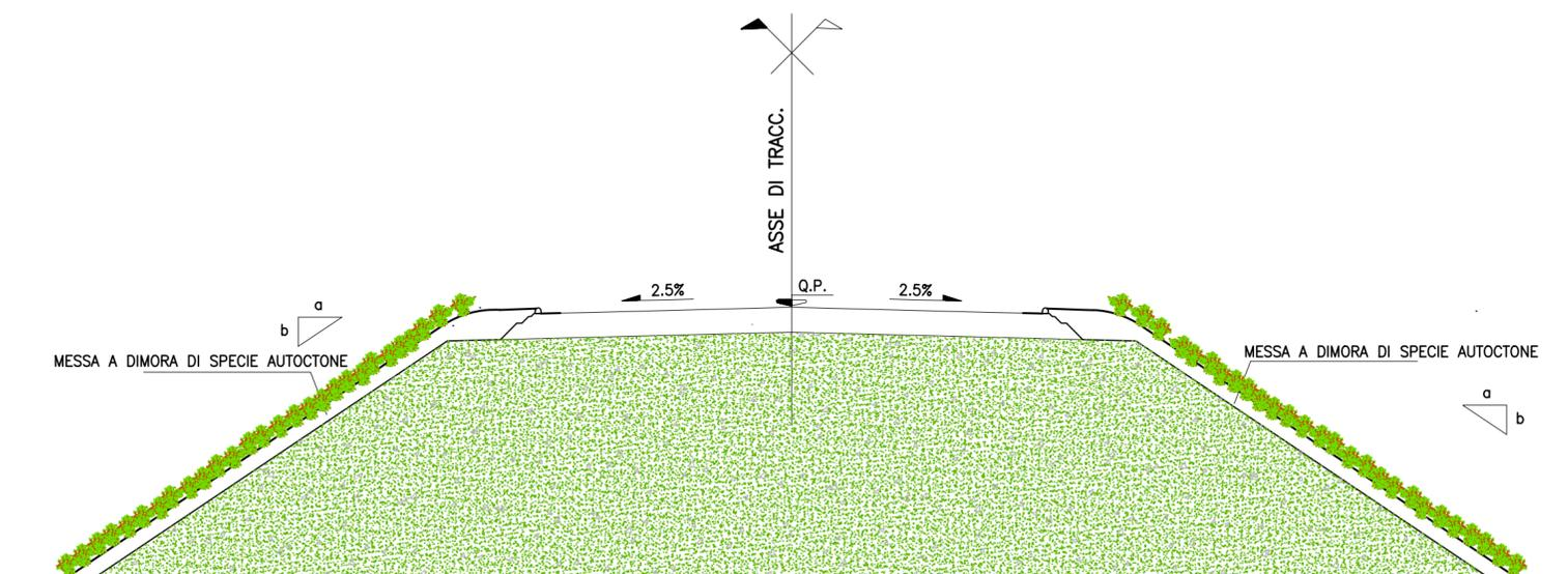
SISTEMAZIONE A VERDE SEZIONE TIPO IN SCAVO
