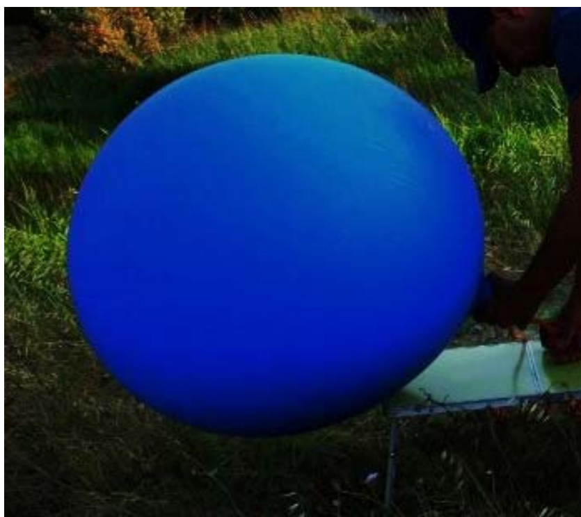
Figura 20 – Preparazione del pallone aerostatico per i rilievi in quota
