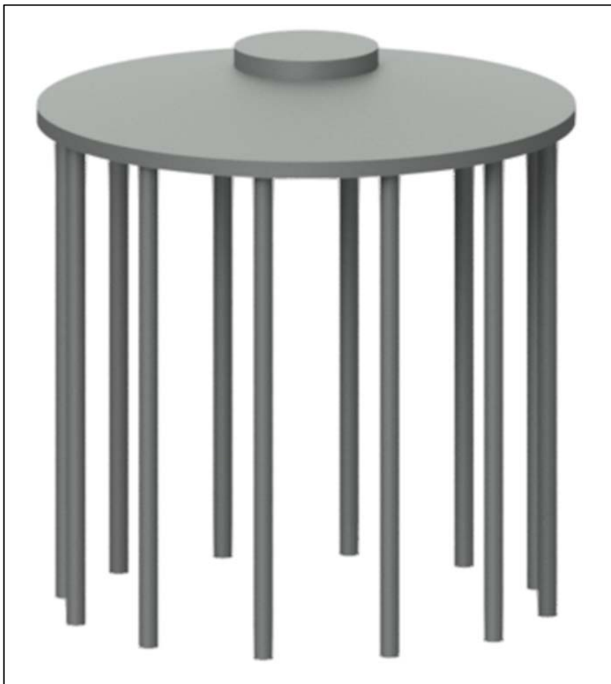
Figura 4: vista tridimensionale della fondazione dell'aerogeneratore
