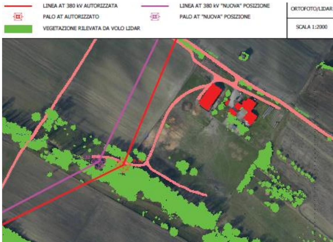
Figura 3-4. Spostamento del sostegno 32 successivo ad approfondimenti condotti in fase esecutiva
