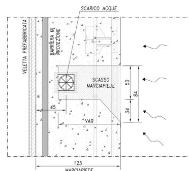
ELEMENTI DI SCARICO-PIANTA scala 1:5
