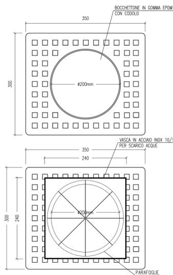
ELEMENTI DI SCARICO-SEZIONE scala 1:5
