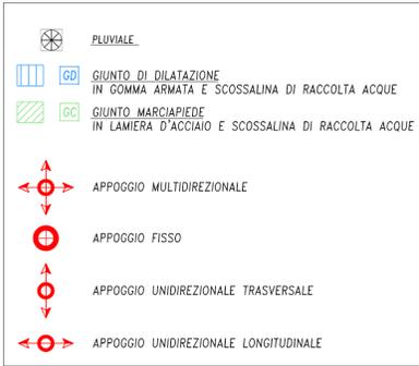
**APPARECCHI D'APPOGGIO IN ACCIAIO TEFLON**
