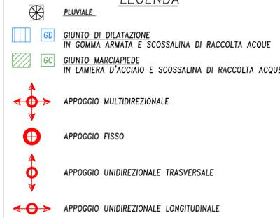
**APPARECCHI D'APPOGGIO IN ACCIAIO TEFLON**
