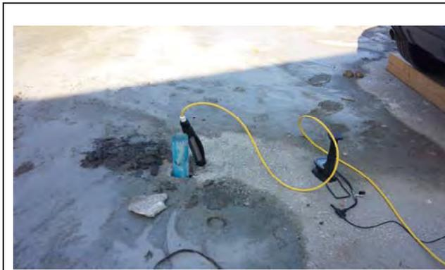
Fig. 2 – Geofono da foro a 5 componenti
