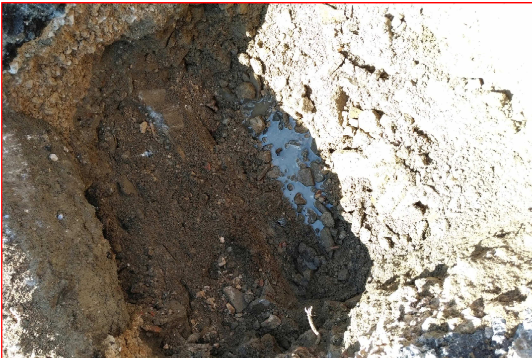
Fig. 6 – Particolare punto SC2: dettaglio stratigrafico, materiale campionato, pareti e fondo scavo
