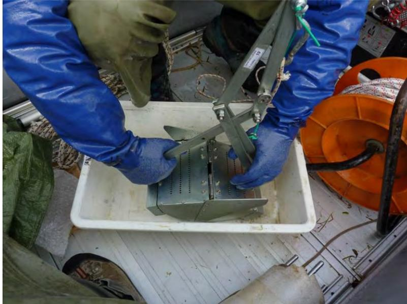
Nel punto individuato per il campionamento la benna viene calata, una volta raggiunto il fondo si chiude automaticamente, raccogliendo il sedimento, e quindi viene recuperata lentamente. Il sedimento viene poi inserito in contenitori idonei, mantenuti in ambiente refrigerato (4 °C) e consegnato al laboratorio di analisi.
