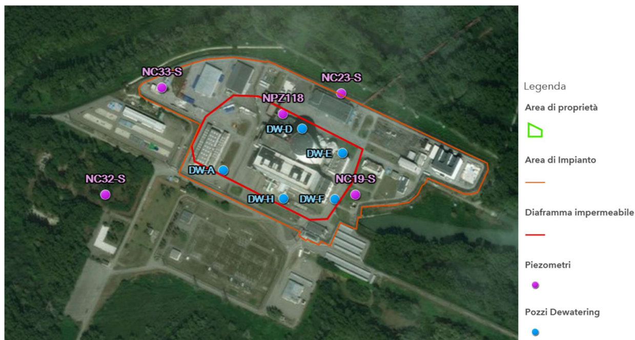
Figura 4.3/3 – Planimetria del sito con ubicazione dei punti di controllo della concentrazione di PCB nelle acque sotterranee
