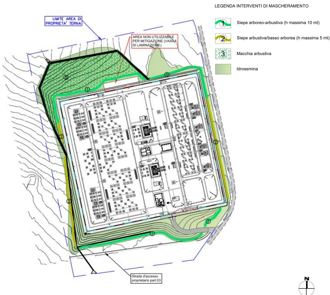
**Figura 2. Schema planimetrico degli interventi.**
