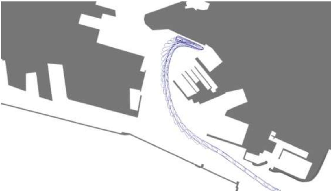
Figura 12 - **M05** – Ingresso nave da crociera (SN in banchina), NE 25 kn, cfg. di progetto
