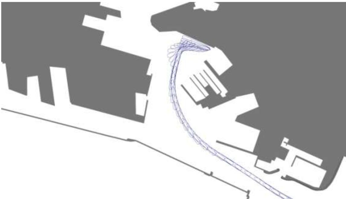
Figura 10 - **M03** – Ingresso nave da crociera (SN in banchina), NE 15 kn, cfg. di progetto
