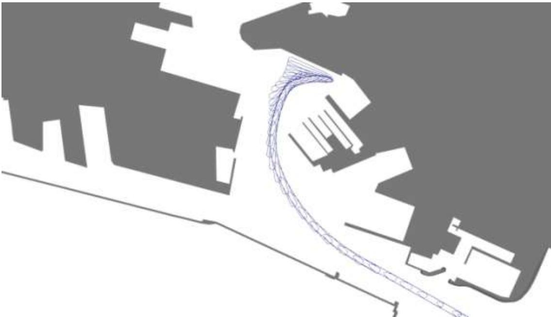
Figura 8 - **M01** – Ingresso nave da crociera (SN in banchina), in calma assoluta, cfg. di progetto
