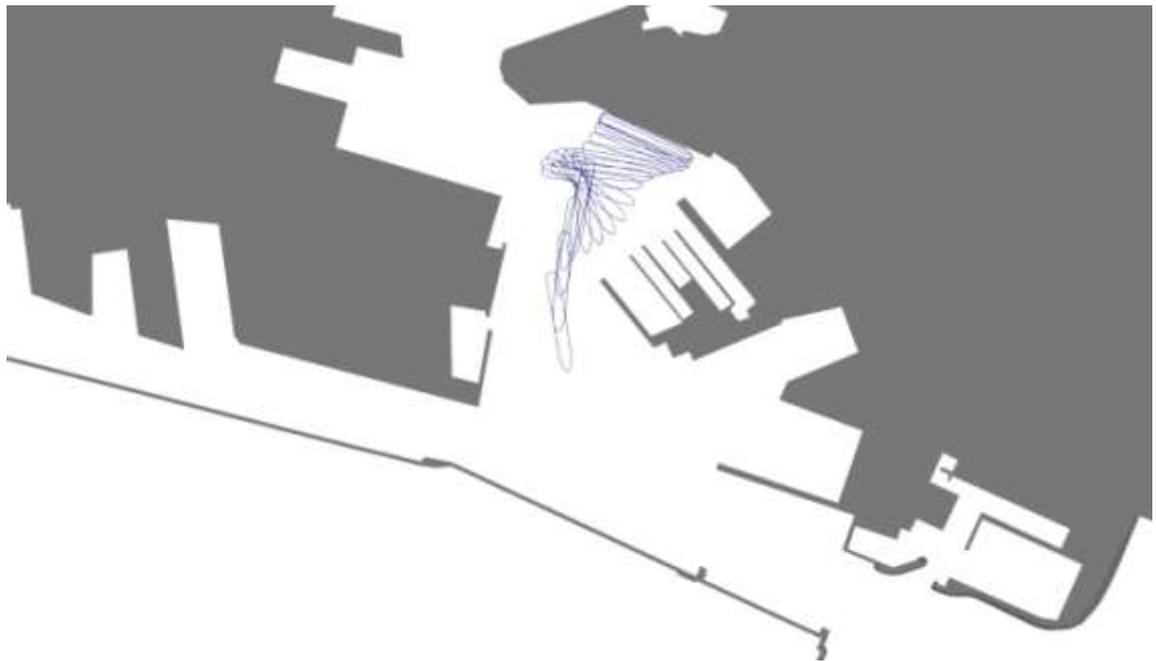
Figura 13 - **M06** – Uscita nave da crociera (SN in banchina), NE 25 kn, cfg. di progetto
