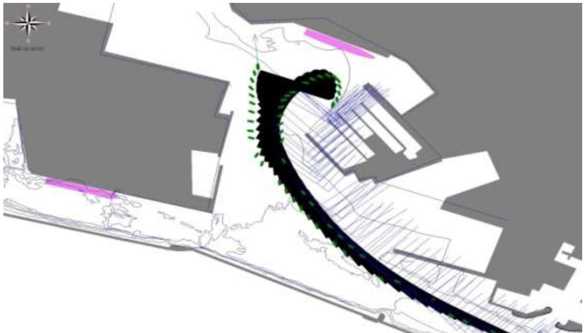
Figura 22 - **M15** – Ingresso nave portacontainer (monoelica), SE 25 kn, 2 rimorchiatori da 75 t, con ingombro su Nuovo Terminal - cfg. di progetto
