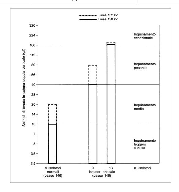
Per le linee che attraversano zone prive di inquinamento atmosferico è previsto l'impiego di catene (di sospensione o di amarro) composto da 9 elementi di tipo "normale".
