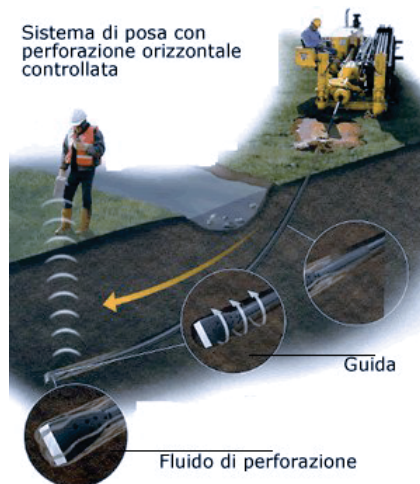
Figura 8- Fasi di lavorazione tecnica TOC
