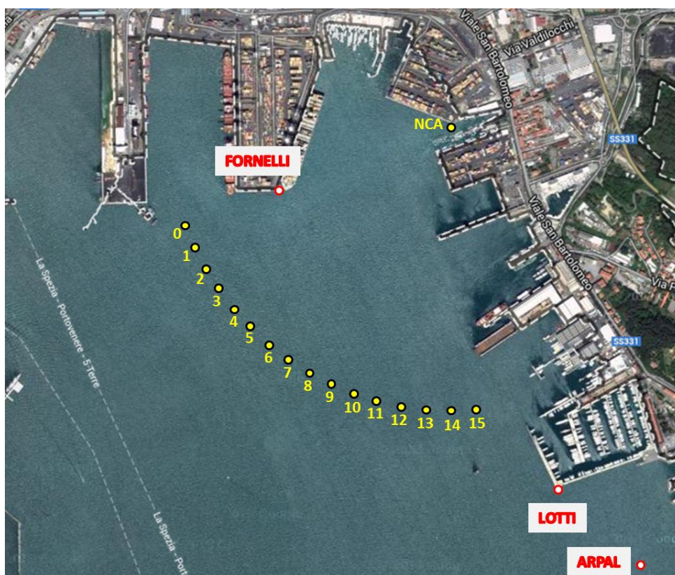
Figura 19 Punti di controllo della temperatura assoluta di 35 °C (NCA) e dell'incremento termico complessivo a 1000 m (dal n° 0 al n° 15) vigenti dall'agosto 2011; il punto per la temperatura fredda indisturbata utilizzato da ARPA Liguria è indicato con la didascalia ARPAL.
