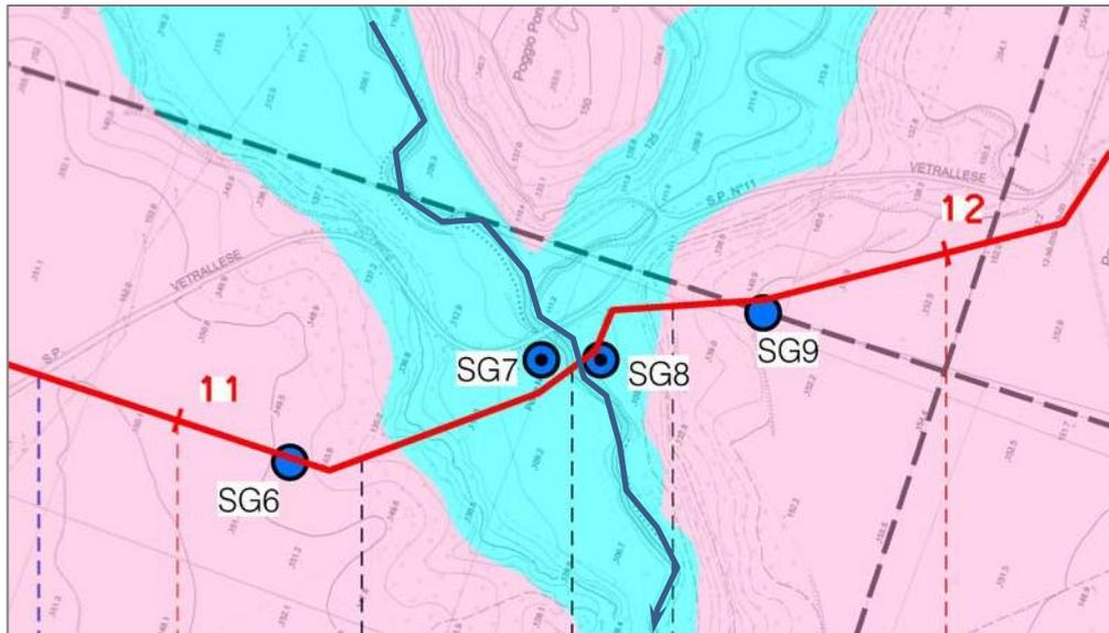
Fig. 4.6/D – Stralcio tavola PG-IG-001 con localizzazione piezometri (SGx), e schema planimetrico della condotta per l'attraversamento del T. Leia (in blu)
