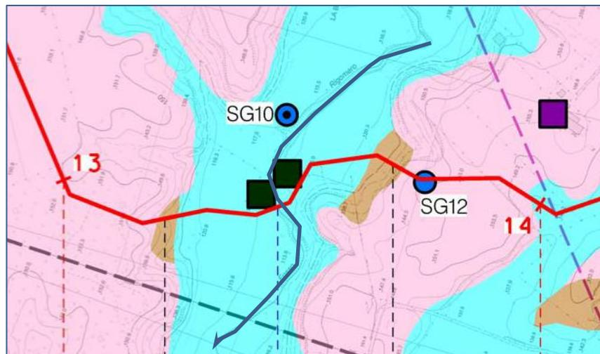
**Figura 4.6/B – Stralcio tavola PG-IG-001 con localizzazione piezometri (SGx), captazioni idro-agricole (quadrato verde) e schema planimetrico della condotta per l'attraversamento del T. Rigomero (in blu)**
