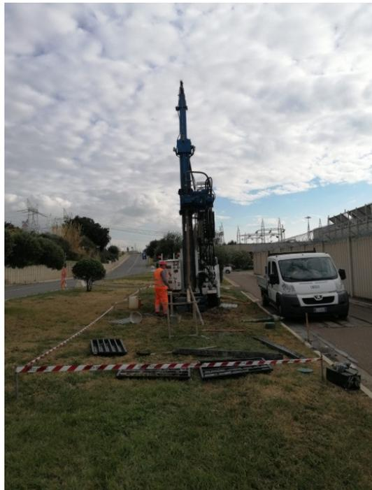
**Fig. 1: Perforatrice CMV MK 800 su trattore Landini**
