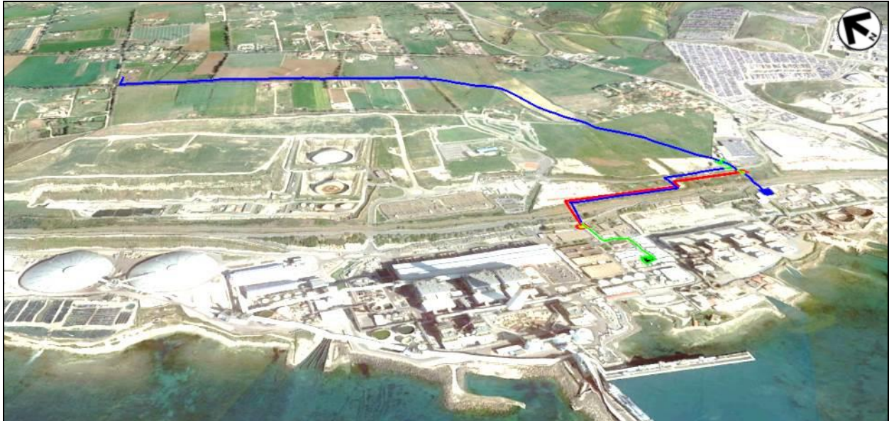
Foto 3.1/A – Immagine 3D dell'area in cui si snoda il tracciato del metanodotto (linea rossa), met esistente (linea blu), in dismissione (linea verde).
