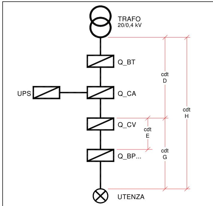
L'origine dell'impianto, caratterizzato da tale livello di tensione nominale, coincide pertanto con i morsetti secondari del trasformatore MT/VT.
