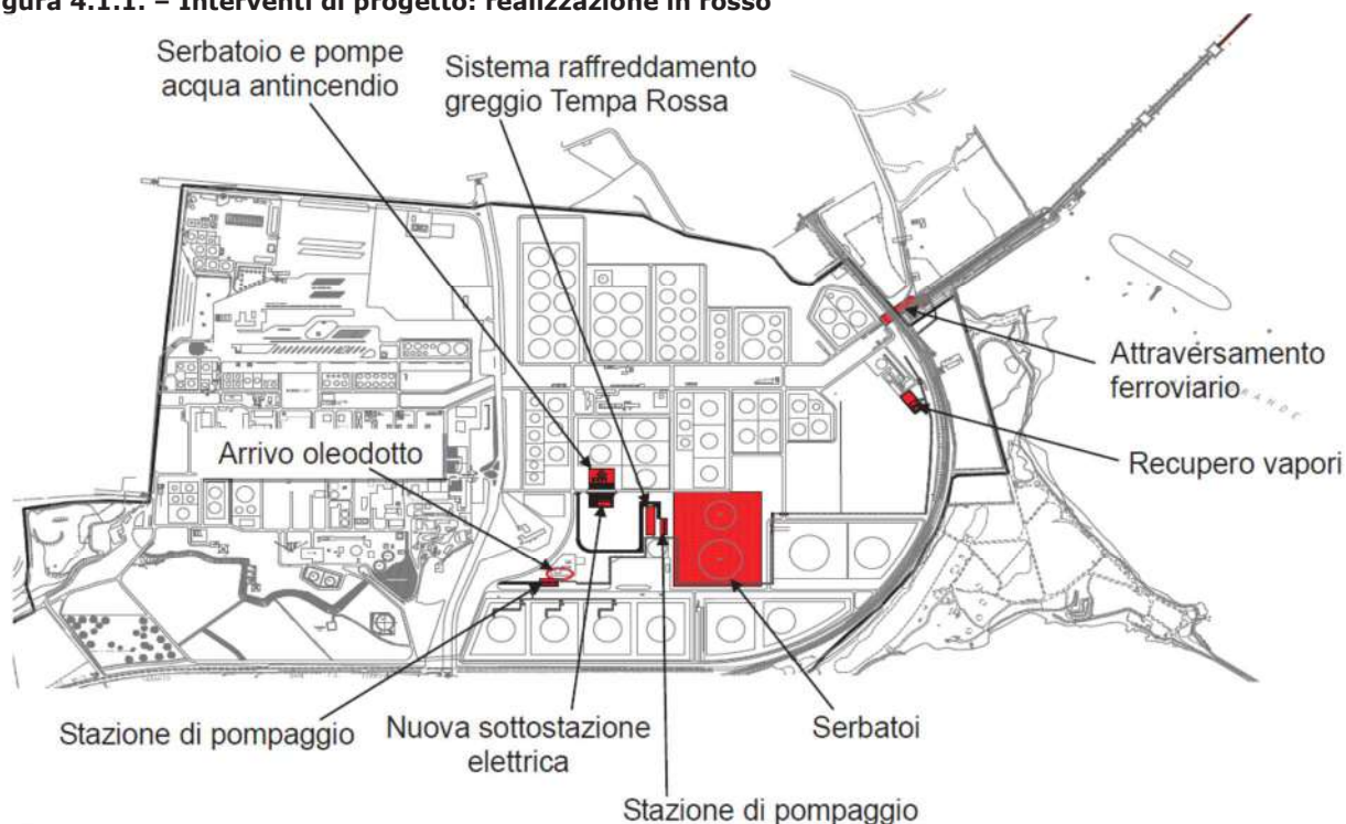
Figura 4.1.1. – Interventi di progetto: realizzazione in rosso
