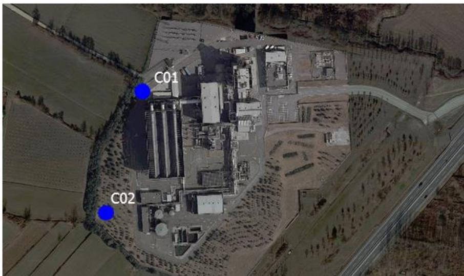
Figura 3-4 Indagini fonometriche per la verifica del clima acustico in corrispondenza della Centrale (misure Cxx)
