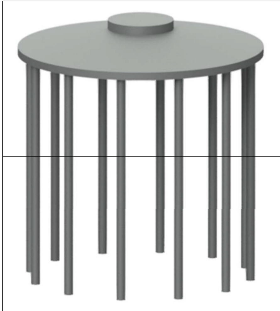
Figura 1 : vista tridimensionale della fondazione dell'aerogeneratore
