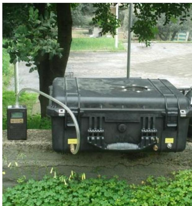
Figura 5.1.1.2-4 VAC-U-Chamber™ in cui è inserito il sacchetto di Nalophan, con pompa a vuoto in attività.
