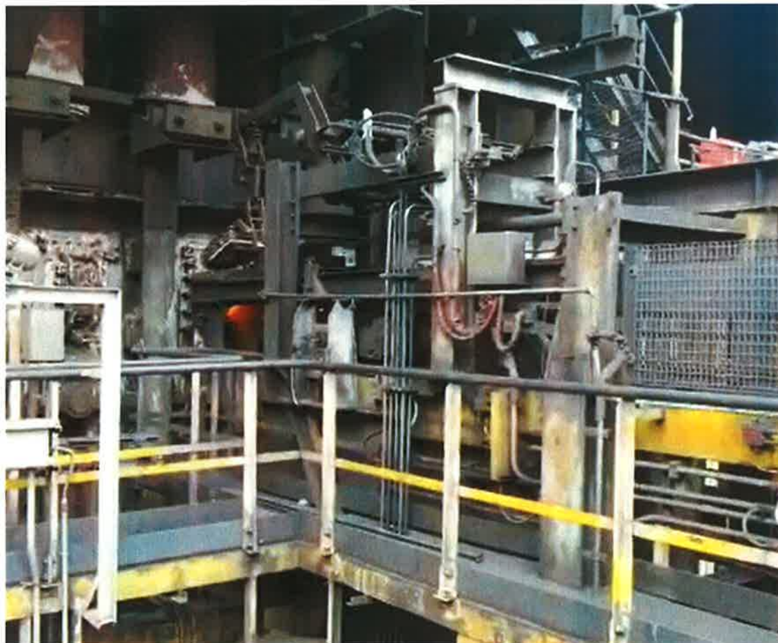
Sistema di apertura delle portine durante lo spianamento con il braccio sollevato.
