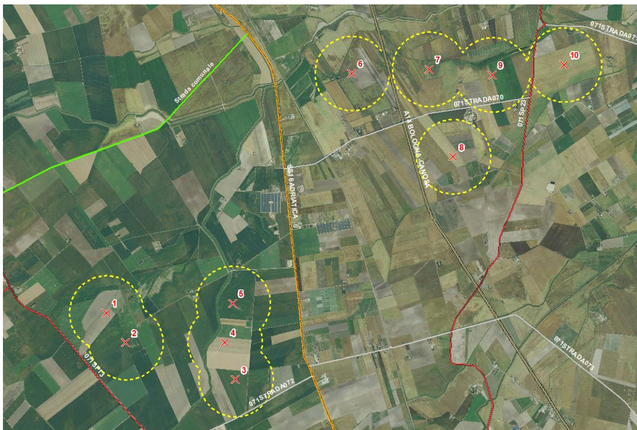
Figura 6: Viabilità interessata dalla rischio di gittata nell'area dell'impianto.
