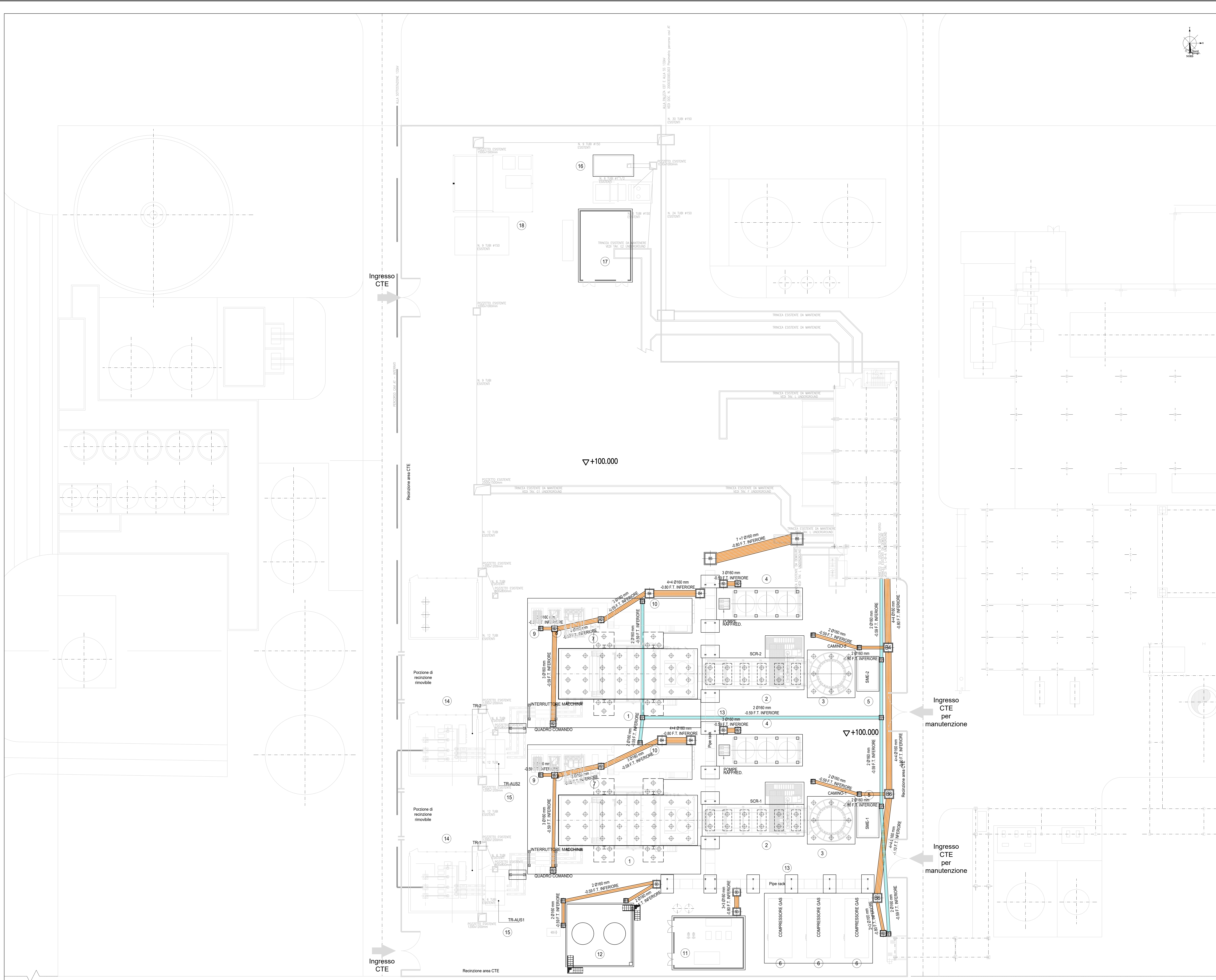
PLANIMETRIA RETI ELETTRICHE INTERRATE Scala: 1:200
