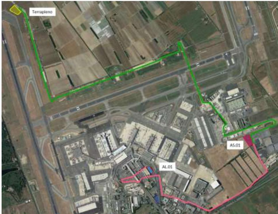
Figura 7-10 Individuazione delle piste di cantiere
