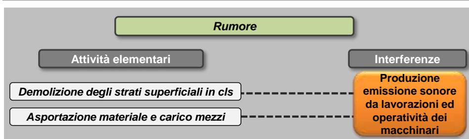
In funzione delle attività elementari individuate nella scheda progettuale relativa all'attività di demolizione delle lastre di cls, i mezzi di cantiere impiegati sono il demolitore per lo smantellamento delle lastre in cls e la terna per l'asportazione degli inerti e successivo carico su camion.
