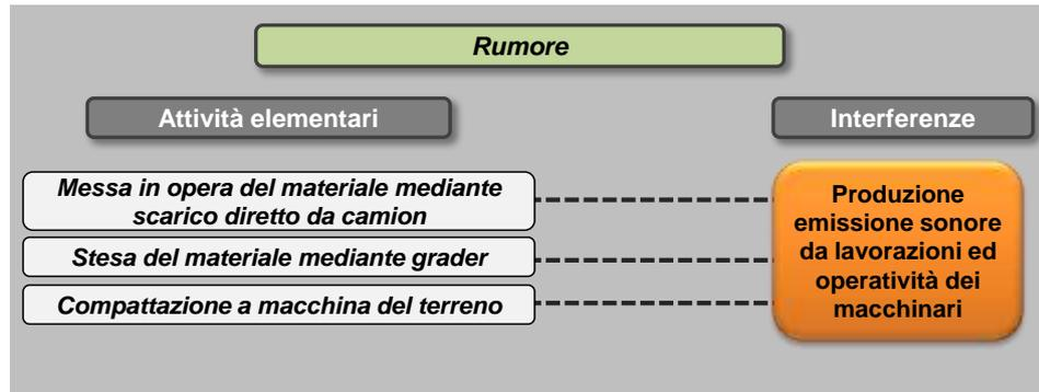
Per la formazione delle sottofondazioni i macchinari impiegati saranno il grader per la stesa del materiale e il rullo per la successiva compattazione. In analogia alle altre lavorazioni le potenze sonore associate a ciascun mezzo, secondo le indicazioni della Direttiva 2000/14/EC, risultano le seguenti:
