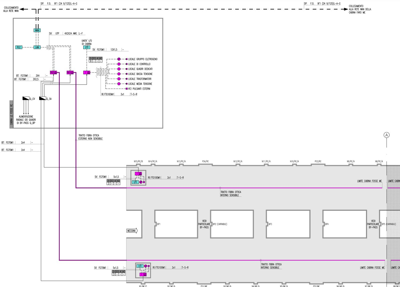
PARTICOLARE COLLEGAMENTI APPARECCHIATURE IN NICCHIA TECNICA E BY-PASS
