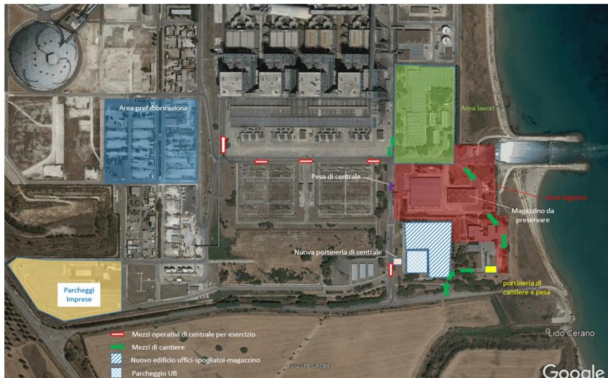
Figura 8 – C.le di Brindisi - Ubicazione delle aree di cantiere
