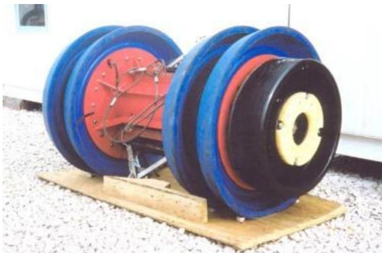
*Figura 3-22 – Pig strumentale per il controllo della geometria e dello spessore della condotta.*
