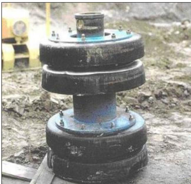
*Figura 3-21 – Pig convenzionale impiegato in operazioni di collaudo idraulico e pulizia della condotta*
