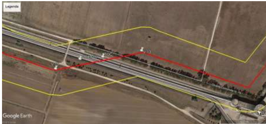
Ortofoto 4 Ricostruzione grafica dell'attraversamento in T.O.C.
