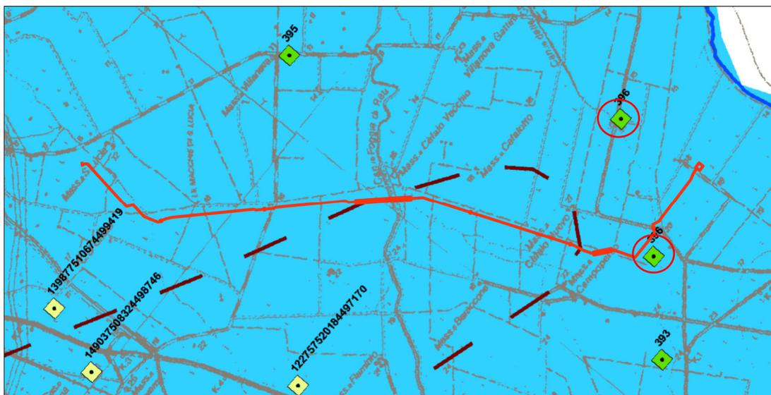
*Figura 3.1.B - Stralci della Carta "Idrogeologica" estrapolata dal P.T.C.P della Provincia di Brindisi (in rosso il tracciato di progetto; quadrato verde pozzo appartenente a Enti idrici e consorzi, quadrato giallo pozzo destinato ad uso irriguo)*
