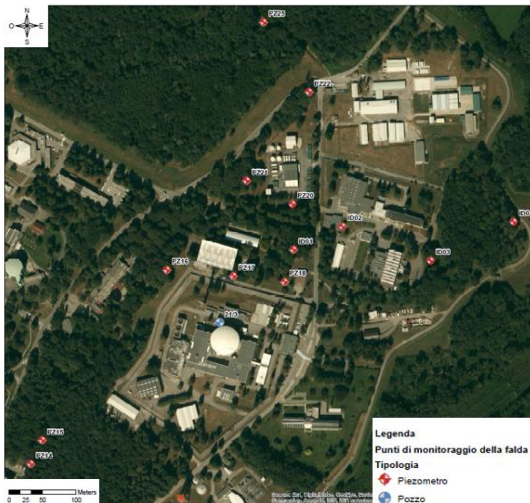
Figura 3-4. Ubicazione dei punti di campionamento acque sotterranee (Fonte JRC).
