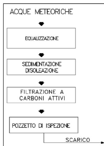
L'impianto in progetto tratterà, in particolare, le acque provenienti dal serbatoio n. 25 del Deposito, che a sua volta raccoglie le acque meteoriche dilavanti provenienti dalla rete di drenaggio esistente. L'impianto avrà un funzionamento in continuo, trattando tutta l'acqua raccolta dalla rete drenante senza separazione tra prime e seconde piogge. Le acque trattate saranno convogliate nella condotta
