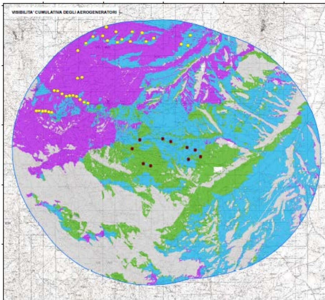
Figura 5- Mappa dell'intervisibilità cumulativi degli aerogeneratori esistenti e in progetto - Metodo 2
