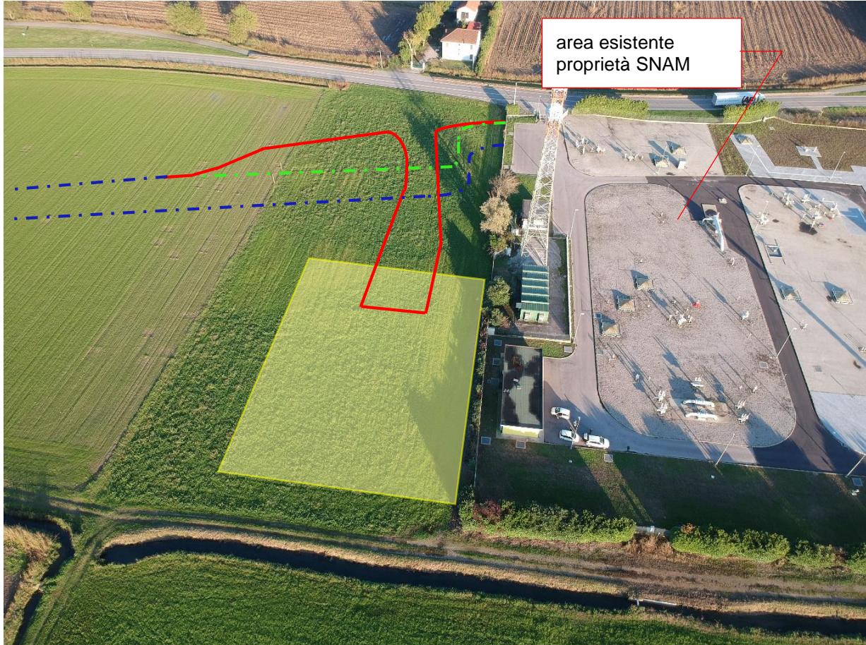
Foto n. 5 - Panoramica della zona prevista per la realizzazione dell'area trappola, in ampliamento all'esistente area Snam di Cervignano d'Adda. L'area in giallo indica la nuova area trappola in progetto, in rosso la tubazione in progetto, in verde quella da dismettere e in blu le linee esistenti.
