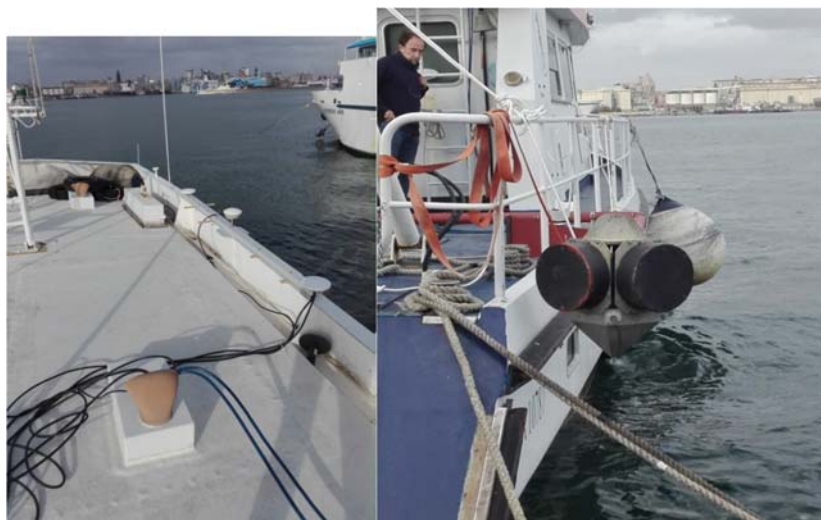
Figura 6.1.2. Antenna per il positioning system (a sinistra) e trasduttori installati sul palo (a destra).
