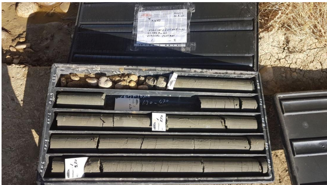
Fig. 14 Sondaggio 1: Passaggio depositi alluvionali a limo con argilla, di colore grigio verde
