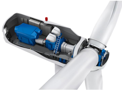
Figura 2. Vestas. Disposizione dei componenti in navicella
