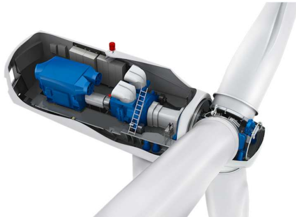
Figura 2. Vestas. Disposizione dei componenti in navicella
