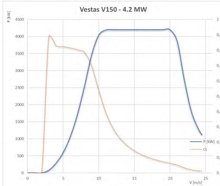
*Figura 6. Curva di potenza di una Vestas V150 da 4,2 Mw*
