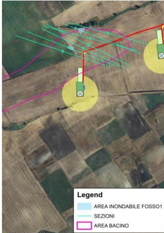
La modellazione del corpo idrico e la valutazione del comportamento dello stesso in condizioni di piena, evidenziano come la piazzola a servizio dell'aerogeneratore WTG01 risulti estranea dagli eventi di piena. L'area dove verrà allocata la piazzola, risulta in sicurezza idraulica.
