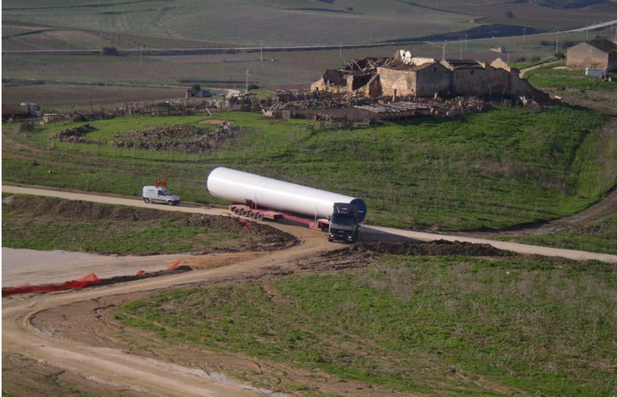
Figura 2: Esempio trasporto pale eoliche – Parco Eolico di Proprietà Troia
