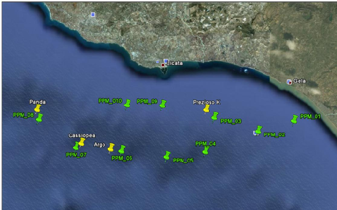
Figura 4-2: ubicazione delle stazioni di campionamento del rilievo ambientale eseguito lungo i due probabili tracciati della futura sealine
